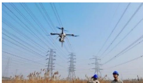
无人机： 巡视厂区内，消除安全隐患。
